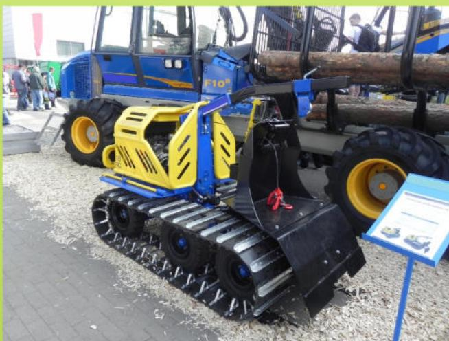
Technika zasahuje do všech oblastí. Tzv. železný kůň mnohde nahrazuje koně „živé“, protože je schopen soustřeďovat dříví i v neúnosných – vodou ovlivněných terénech.
