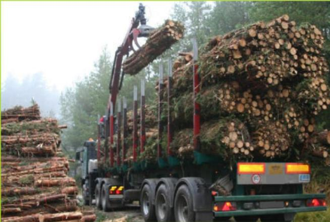
Vývoj nezastavíš! Doba kácení stromů ruční pilou břichatkou a doprava dříví na saních tažených koňmi je dávno pryč. Tato práce je v současnosti ze značné části prováděna harvestory a vyvážecími soupravami
