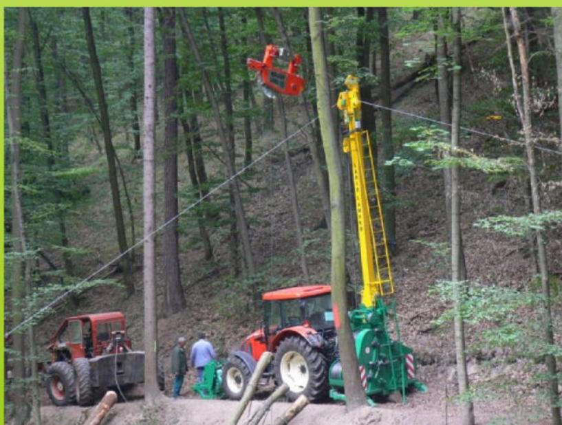
Z extrémně svažitých terénů bývá dřevní hmota těžena – soustředována lanovkou. Pracovní pole bývá většinou pruh mezi svážnicemi ležícími nad sebou. Šíře pole je závislá na dosahu pracovního lana. Náklady na těžbu, resp. soustředění jsou násobně vyšší než kolovou technikou – pohybují se kolem 600 Kč/m<sup>3</sup>.
