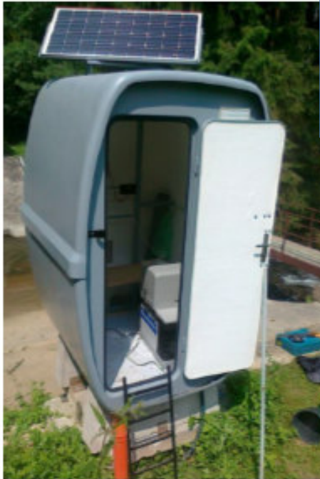
Obr. 7. Automatická vzorkovací stanice Sedlický potok – Leský mlýn
