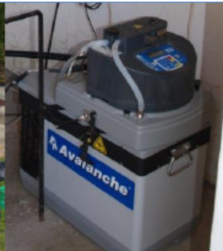
Obr. 7. Automatická vzorkovací stanice Sedlický potok – Leský mlýn
