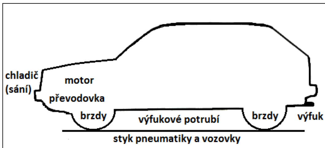
Obrázek 99: Hlavní zdroje hluku u osobního automobilu.
