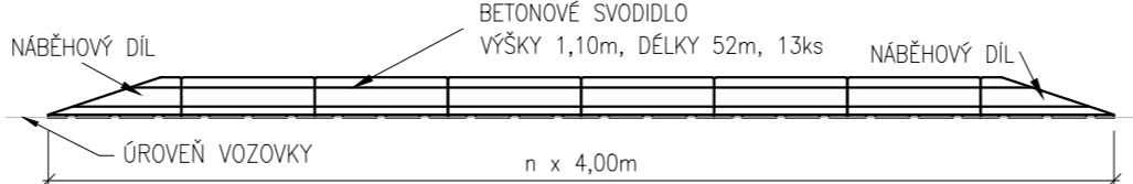
POHLED NA SVODIDLO 1:250
