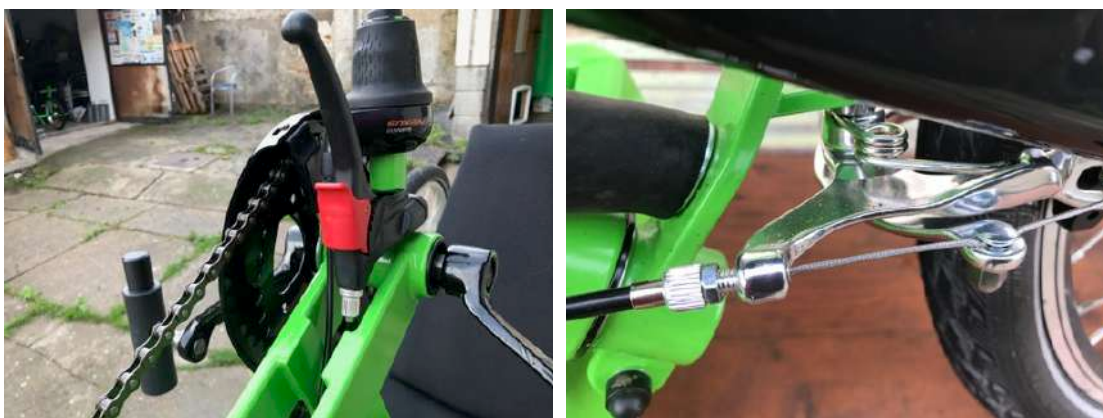
grip shift a páka brzd, čelistová brzda
