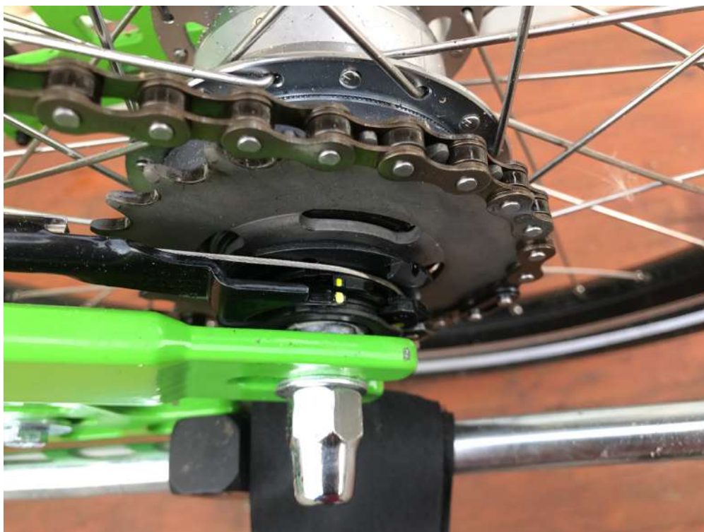
převodovka - seřizovací značky
