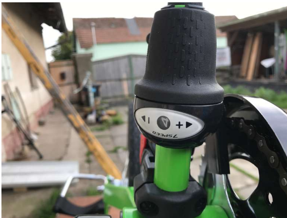
grip shift a indikátor rychlostního stupně
