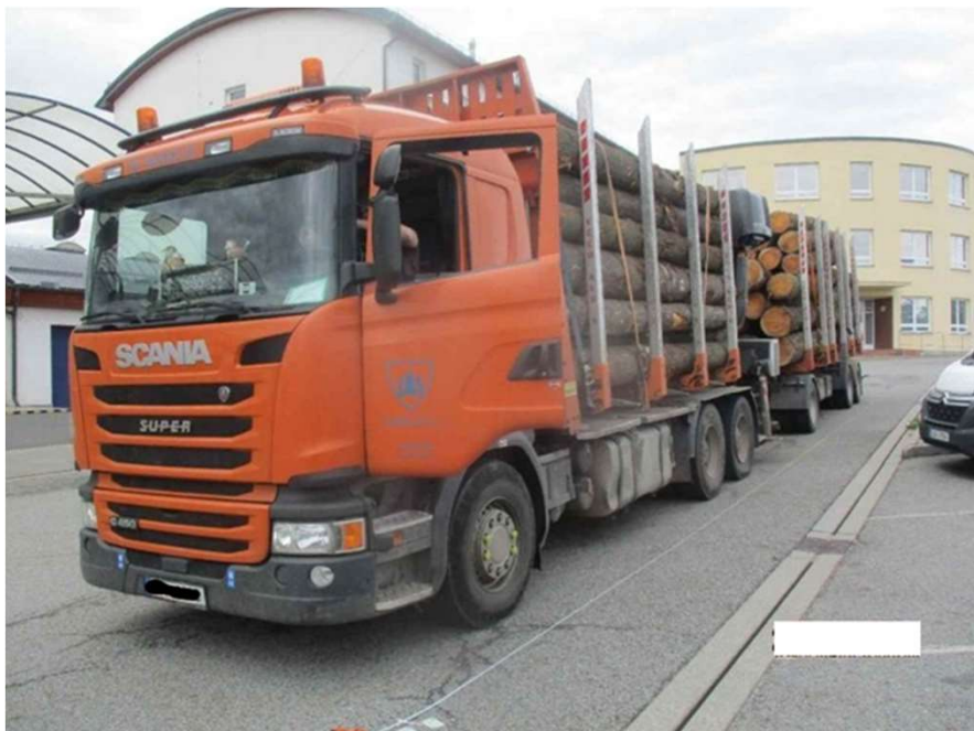
Překročení největší povolené hmotnosti jízdní soupravy stanoveno 48 000 kg, technickým zařízením zjištěno 56 931 kg
