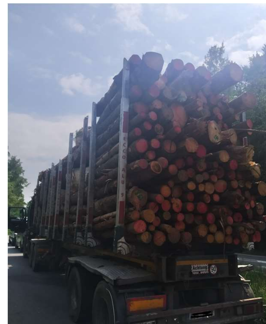
Překročení největších povolených rozměrů stanoveno 4,08 m – kontrolním měřením zjištěno 4,76 m
