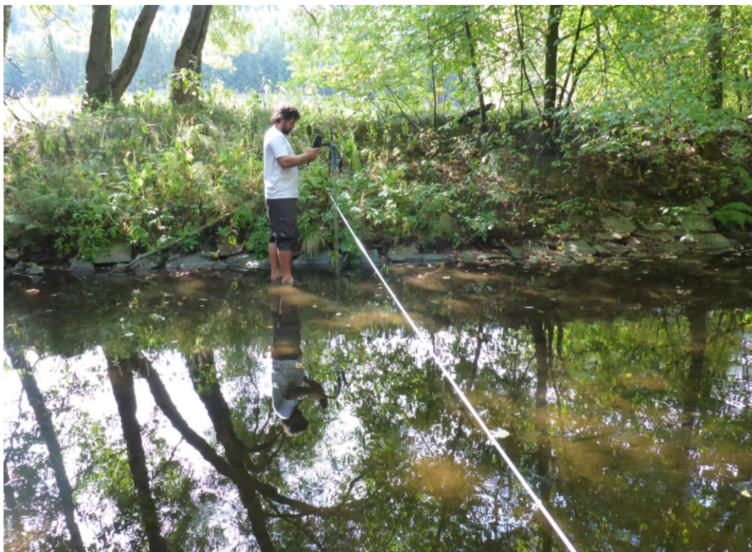
Obr. 8 Měření průtoku přístrojem FlowTracker v profilu Borovnice na Svratce (22. 8. 2018).
